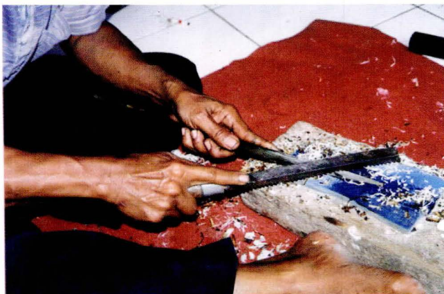
Proses Pembersihan dan Pembentukan Calon Gapit
